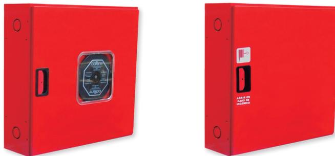
Boca de Incendio Equipada Ø25 mm según norma UNE/EN 671-1 y 20 m de manguera semirígida fabricada según EN 694:2001.
