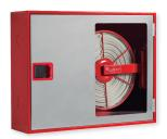
Boca de Incendio Equipada Ø45 mm según norma UNE/EN 671-2. Modelo P6420 con 20 m de manguera plana y 15 m el modelo P6415.
