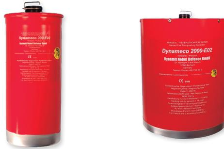
El sistema se basa en la colocación de unos generadores de SOYUZ en el habitáculo a proteger, los cuales, cuando son activados eléctricamente, queman una mezcla pirotécnica que genera un aerosol finalmente difundido por el entorno compuesto de carbonato de potasio ( $K_2CO_3$ ), el cual, es una sustancia NO TÓXICA que interviene eliminando la formación de los radicales que aparecen asociados al fuego y absorbiendo su energía de combustión, por lo que dicho fuego queda extinguido.
