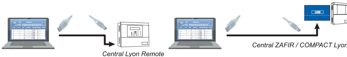
Conexión para 1 central mediante protocolo RS485 o TCP/IP (versión ampliada)
