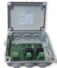
Módulo analógico microprocesado y direccionable (con aislador de cortocircuito) que se instala como un elemento más del bucle.
