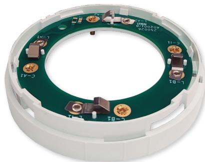
Para facilitar la tarea de actualización de los detectores de la gama A30X a los nuevos detectores de la gama A50, Cofem dispone de una "base de interconexión", que permite colocar los nuevos detectores sobre los zócalos de la gama anterior, sin necesidad de cambiar ni cablear de nuevo los zócalos.
