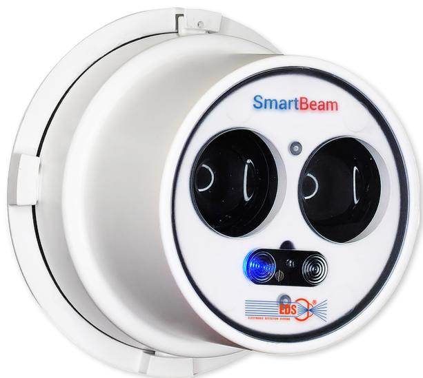
El detector DLRCM es un detector de humo óptico lineal con microprocesador auto regulable motorizado, que basa su funcionamiento en la interacción entre el humo presente en un ambiente y un rayo infrarrojo emitido por el dispositivo y reflejado por un reflector óptico.
