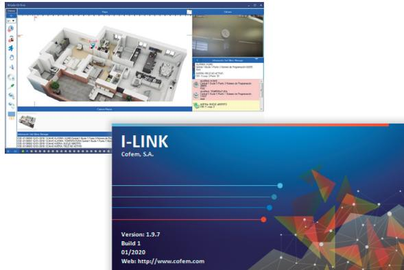
I-LINK es un software de configuración y monitorización de las centrales algorítmico-direccionables de Cofem.
