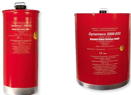
El sistema se basa en la colocación de unos generadores de SOYUZ en el habitáculo a proteger, los cuales, cuando son activados eléctricamente, queman una mezcla pirotécnica que genera un aerosol finalmente difundido por el entorno compuesto de carbonato de potasio ( $K_2CO_3$ ), el cual, es una sustancia NO TÓXICA que interviene eliminando la formación de los radicales que aparecen asociados al fuego y absorbiendo su energía de combustión, por lo que dicho fuego queda extinguido.
