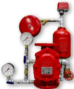
Equipo de alarma y control para sistema de rociadores. El agua permanece presurizada en las tuberías y se libera sobre el área del incendio después que el rociador se activa debido al fuego. El interruptor de presión envía la información de la alarma al sistema de alerta de incendios o al sistema de automatización. Después de que el interruptor de presión se activa, el agua pasa al gong del motor de agua y activa una alarma mecánica.
